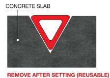
**PLASTERING GROOVE LINE 25MM** -13X27MM
